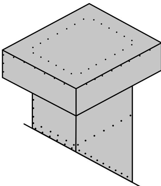
Durch den Einsatz unserer vierseitig offenen Dachhauben ist die Lüftung und Entrauchung des Aufzugschachtes auch bei hohen Windgeschwindigkeiten – unabhängig von der Windrichtung oder Witterung – gewährleistet.
