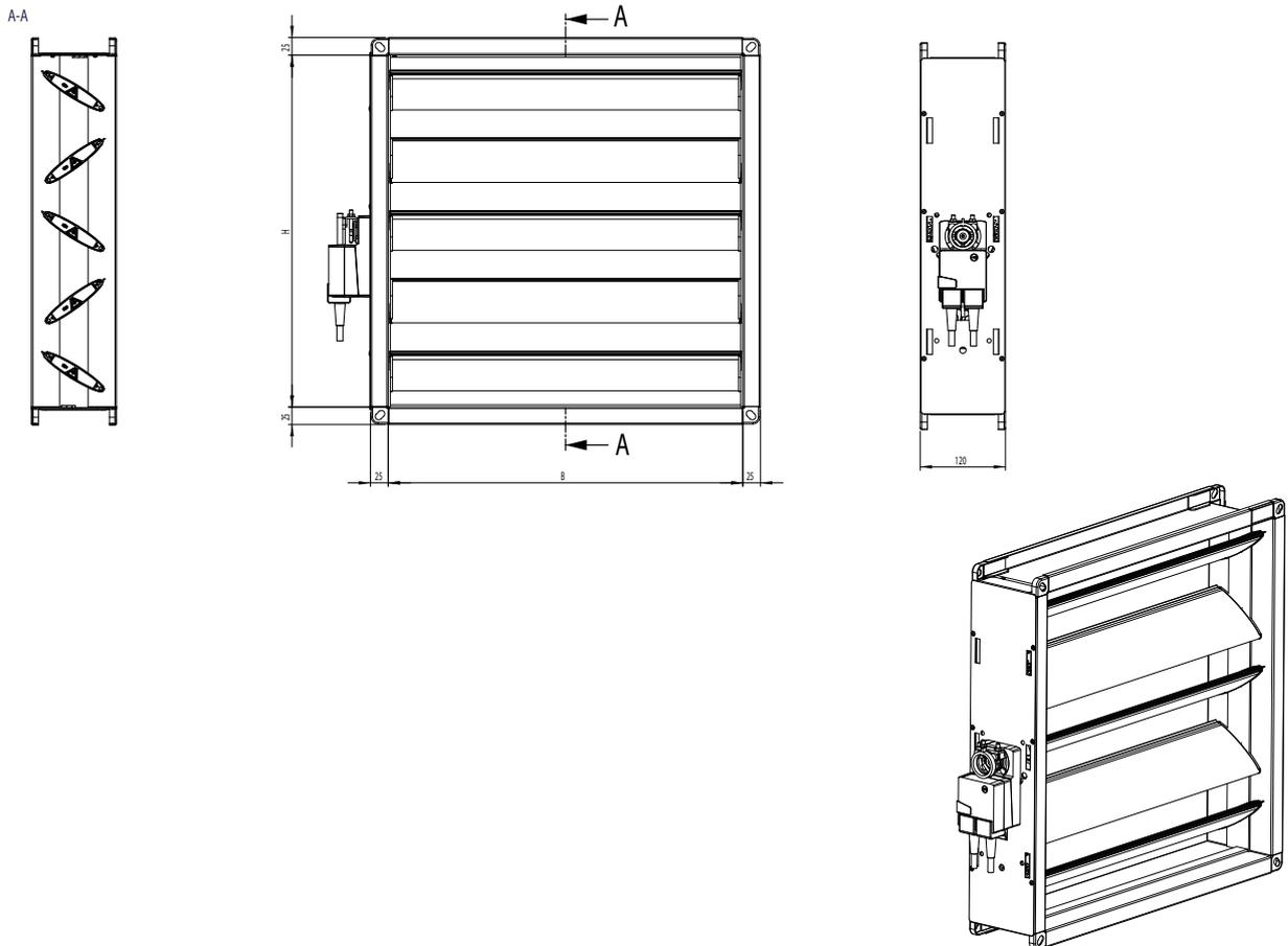
**NK-SL = Jalousieklappe mit Federrücklaufmotor**
